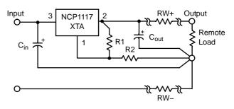
Figure 23. Load Sensing
