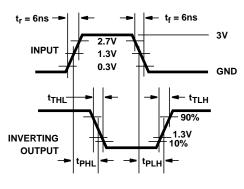
FIGURE 5. HCT TRANSITION TIMES AND PROPAGATION DELAY TIMES, COMBINATION LOGIC
